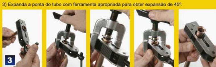
3) Expanda a ponta do tubo com ferramenta apropriada para obter expansão de 45°.
