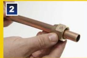
2) Coloque a porca no tubo com o lado rosca voltado para a extremidade do tubo a ser expandida.
