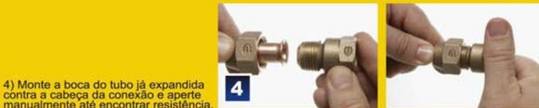
4) Monte a boca do tubo já expandida contra a cabeça da conexão e aperte manualmente até encontrar resistência.
