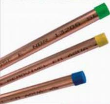
Os tubos de cobre **HIDROLAR®** são rígidos, **sem costura**, fabricados pelo processo de extrusão e em seguida calibrados nos diâmetros comerciais por trefilação. São produzidos de acordo com a norma ABNT-NBR 13206\*. Comercializados em barras de 5,0 e 2,5 metros.
